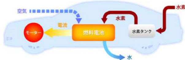
燃料電池自動車の仕組み（出典：ふくおかFCVクラブHP）
